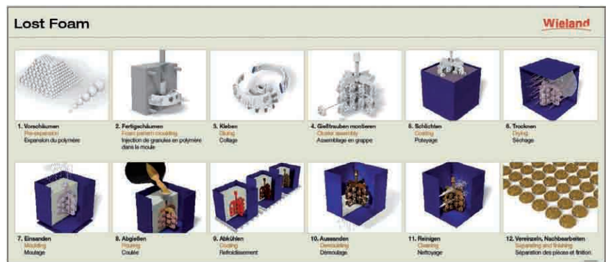
Bild 3: Die Arbeitsschritte bei der Lost Foam-Gussfertigung.
