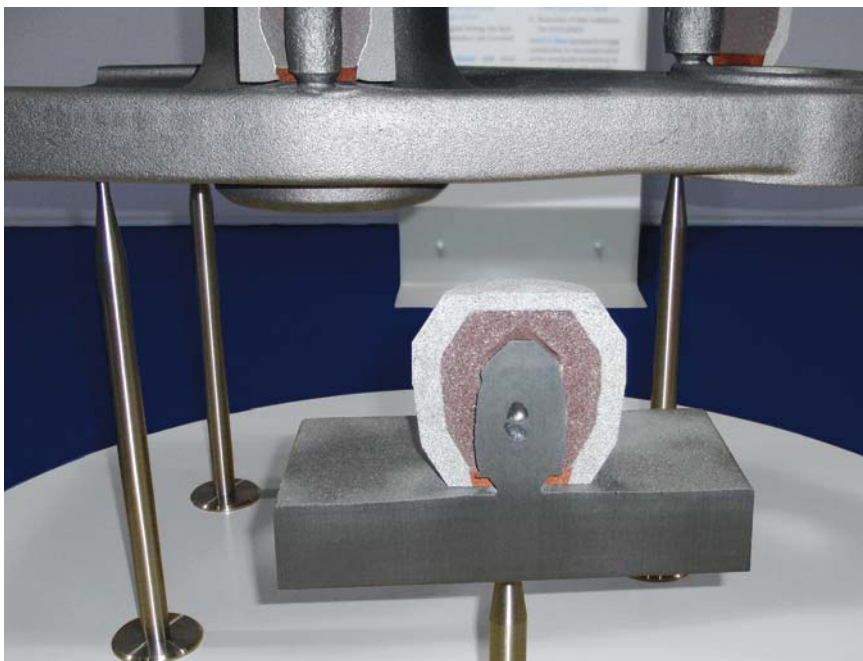
Bild 4: Modulplatte mit Lunkerbild.
