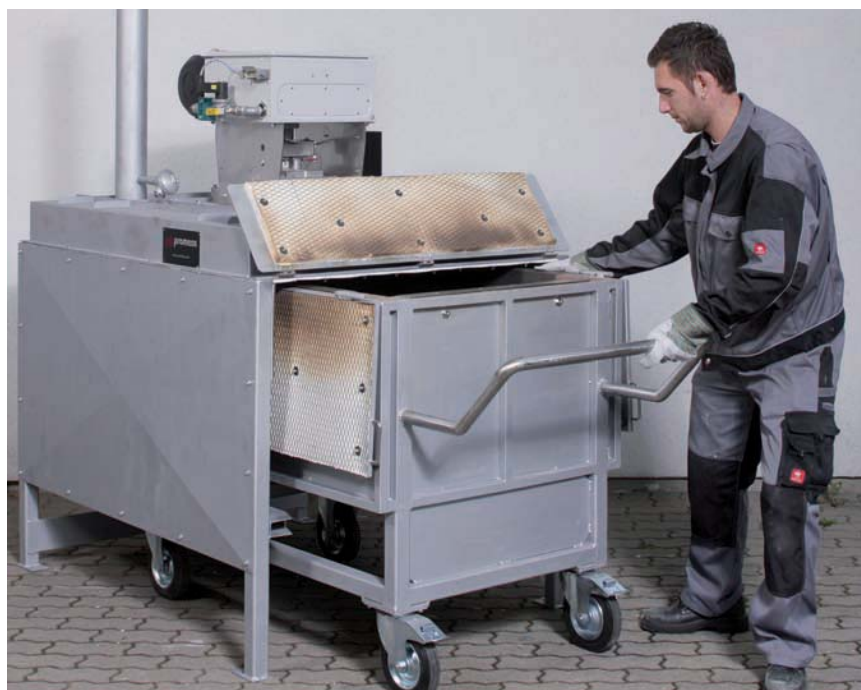
Bild 4: Haubenofen für Werkzeugtemperierung.
