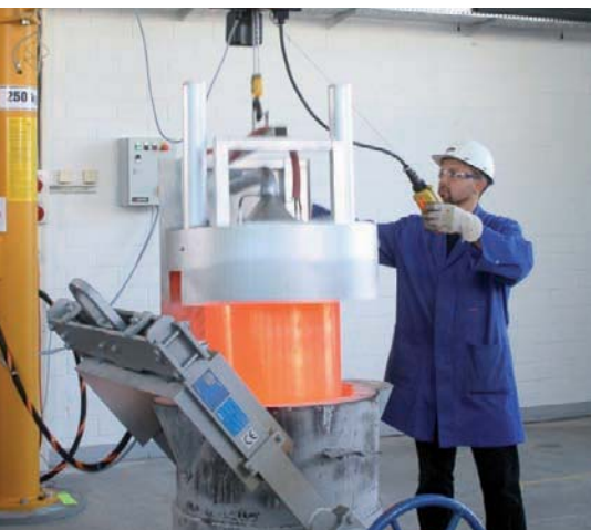
Bild 1: Pfannenbeheizungssystem für Aluminium (1,25 t) mit 100 kW-Brenner.
