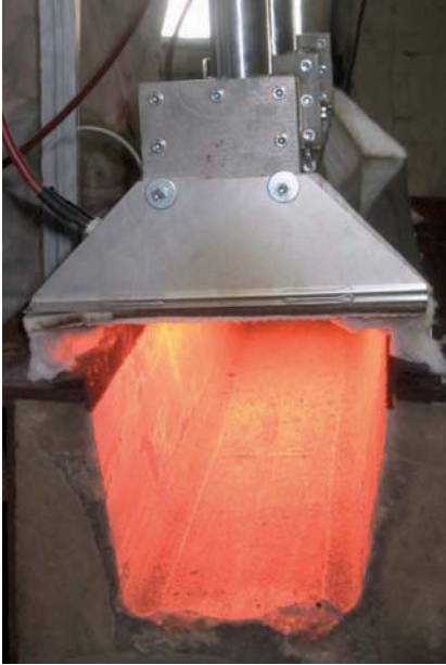
Bild 2: Rinnenheizung von oben.
