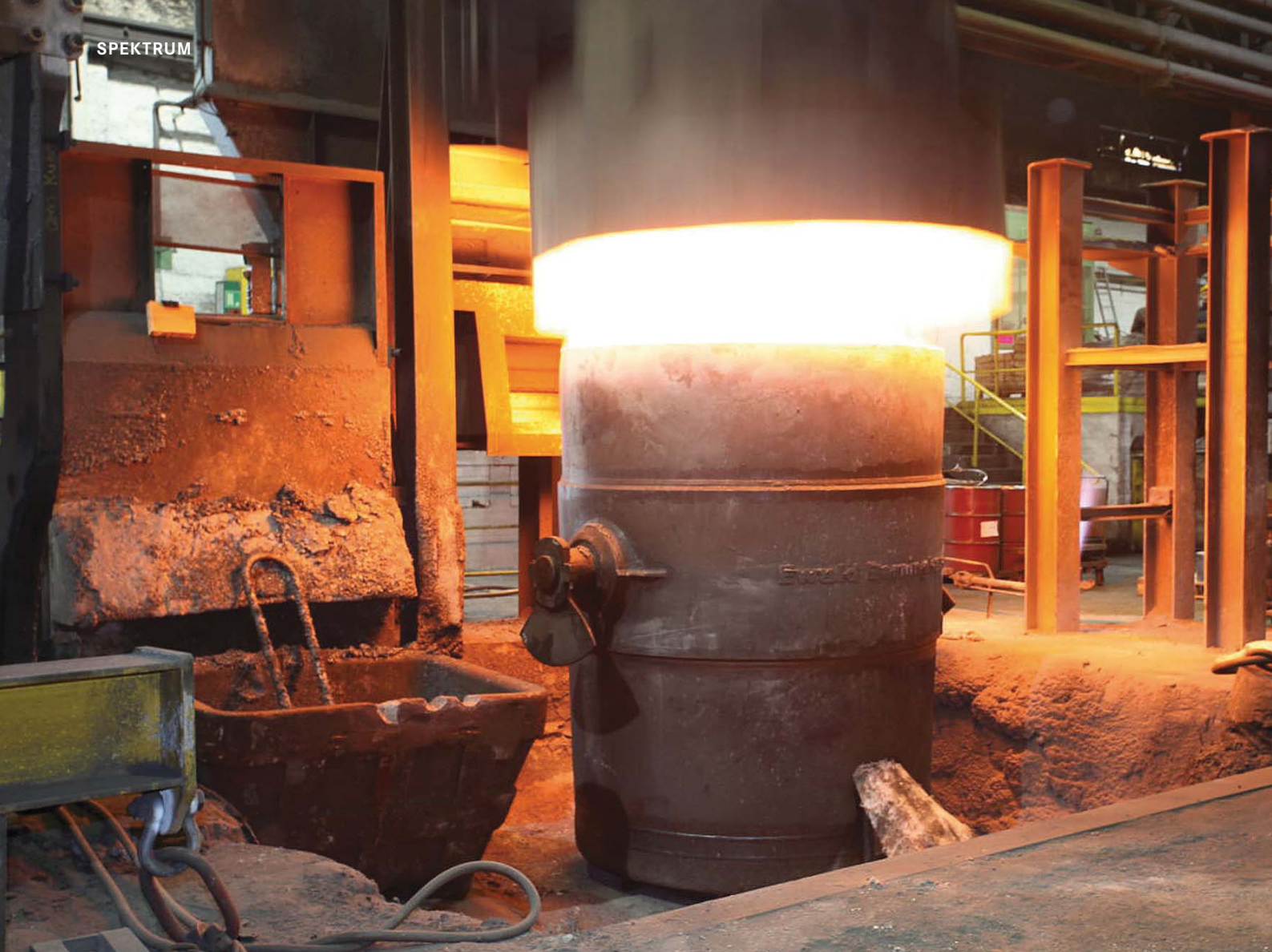
Magnesiumbehandlung in der Friedrich Wilhelms-Hütte mit Tauchpfanne und Tauchglocke unter effizienter Nutzung der Pfannenrestwärme.
