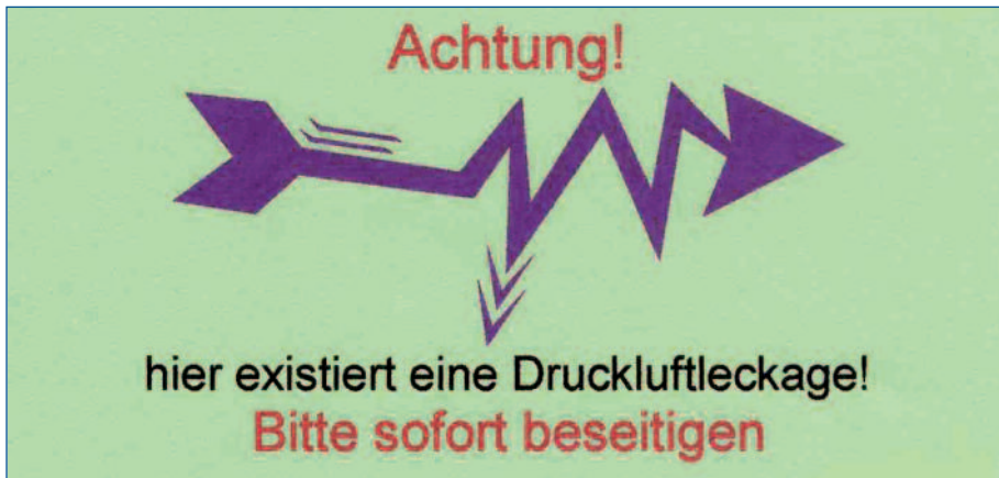
Abbildung 1.5b: Markierungsmöglichkeit einer Druckluftleckage
