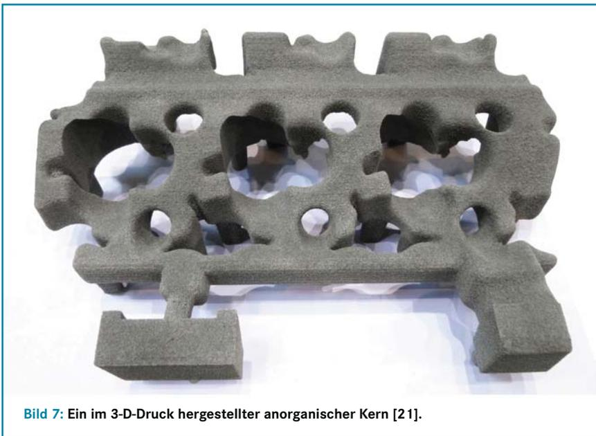
otec eingesetzt. Dieses Bindemittel setzt nahezu keine umweltbelastenden Emissionen frei und ermöglicht dennoch die Herstellung von komplexen Sandkernen, wie sie für die Herstellung von hoch effizienten Otto- und Dieselmotoren für die Pkw-Produktion notwendig sind. Neben dem Umweltaspekt eröffnet dieses neue Fertigungsverfahren weitere Potentiale hinsichtlich Qualität, Kosten und Bauteileigenschaften.
