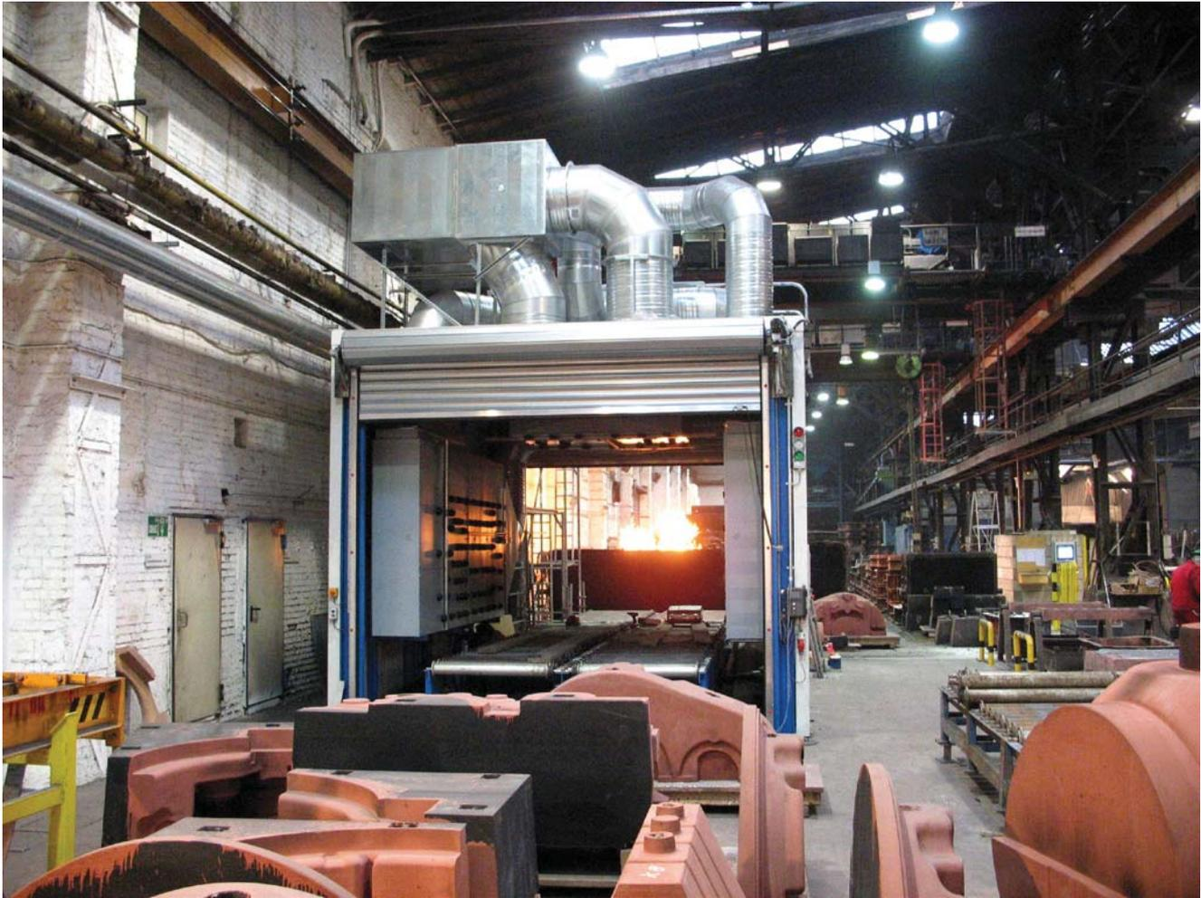
**Bild 8:** Durchlauftrocknungskabine für wassergeschichtete Kerne und Formen aus dem Klein- und Mittelguss [22].
