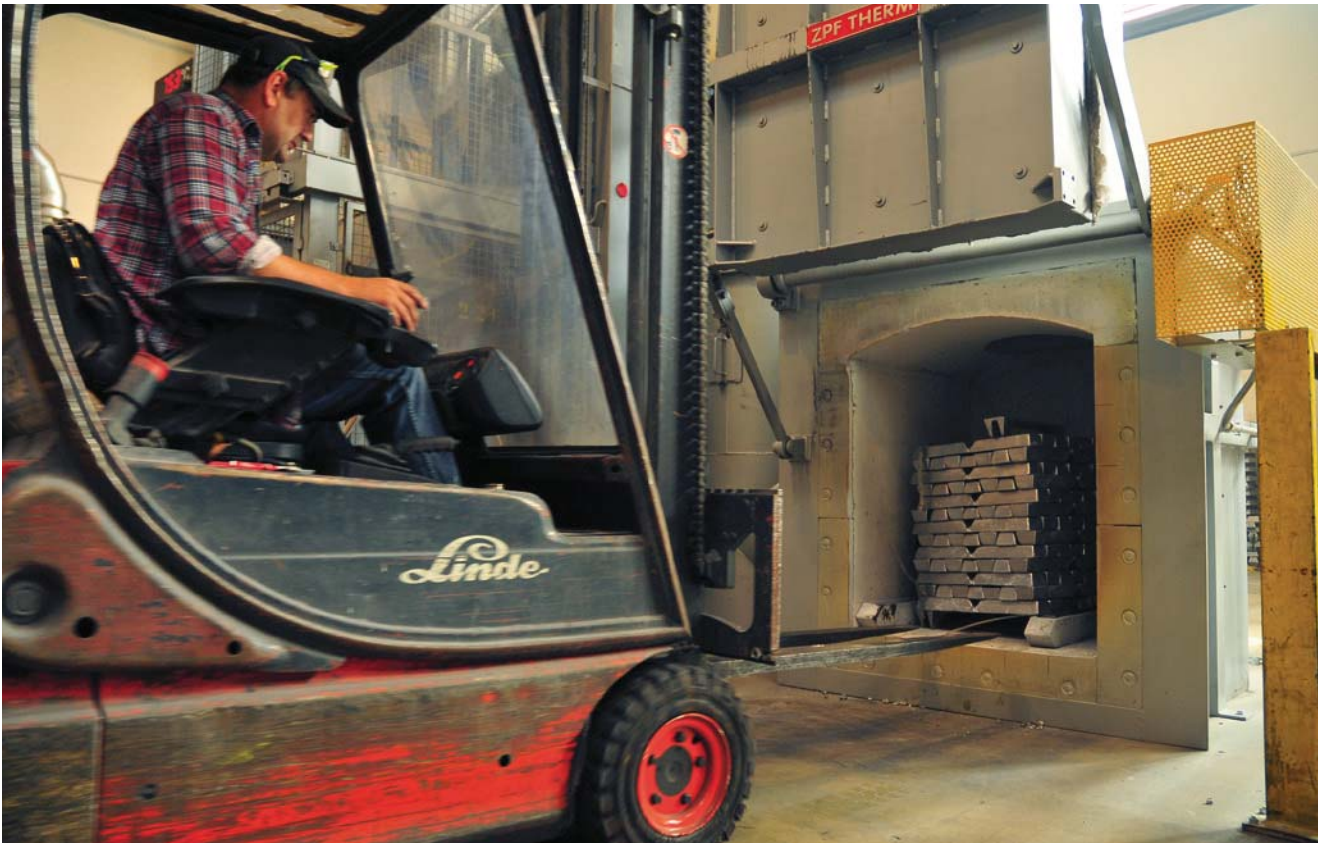
Bild 1: In der neuen Vorwärmkammer werden Massel-Pakete von circa 500 kg rund zwei Stunden auf 200 °C temperiert. Dadurch sinkt der Energie- und Zeitbedarf beim anschließenden Schmelzen.
