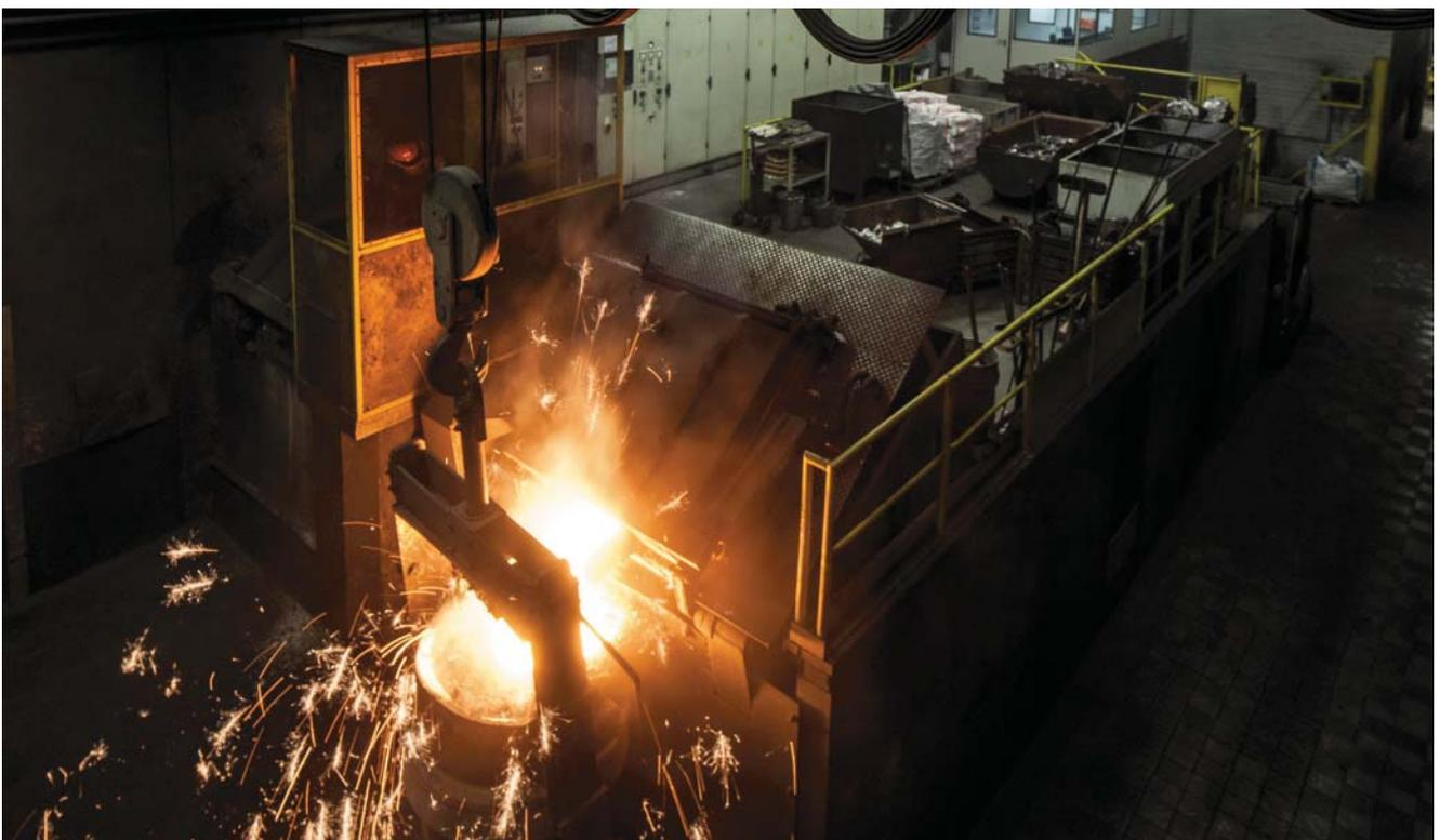
Bild 2: Mittelfrequenzelektrofen mit Steuerstand.
