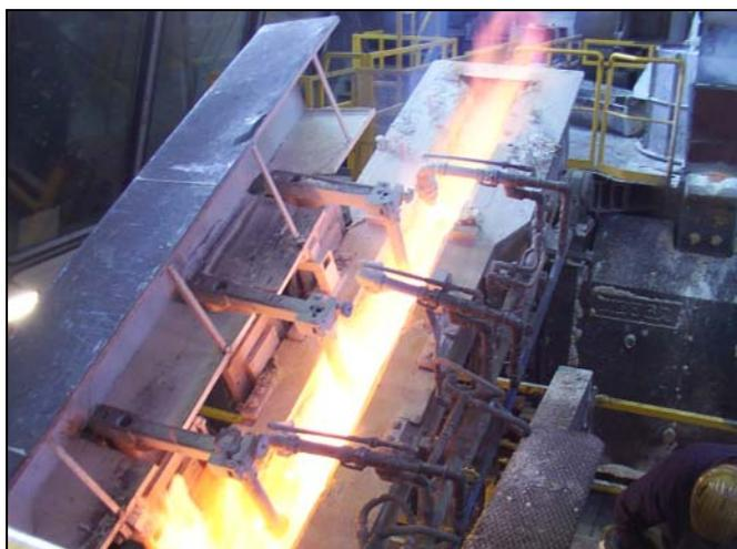
Abbildung 6-14: Ansicht einer mittels Gasflammen beheizten offenen Gießrinne
