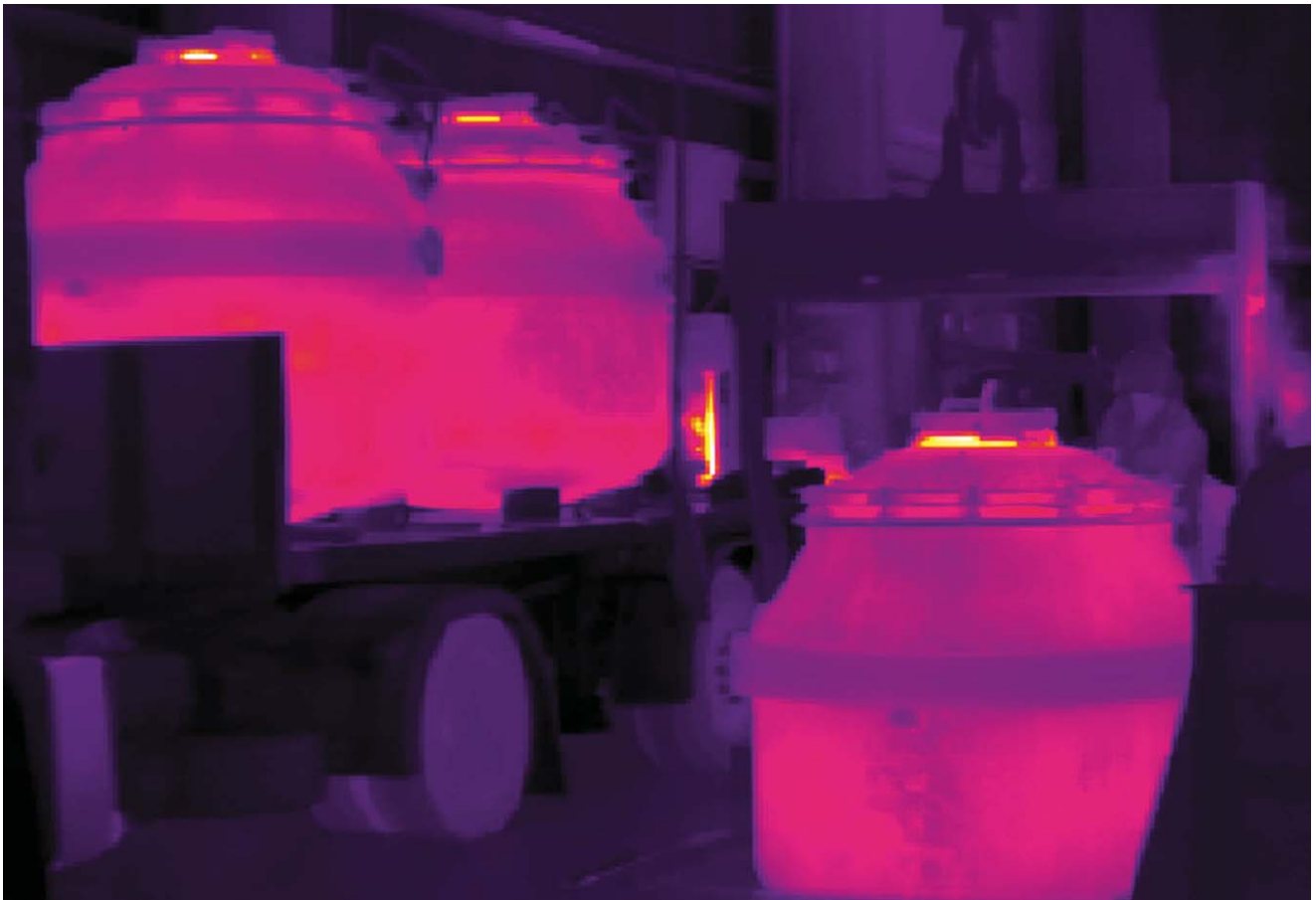
Wärmebildaufnahme eines Lkws während des Beladens mit Aluminiumtiegeln.
