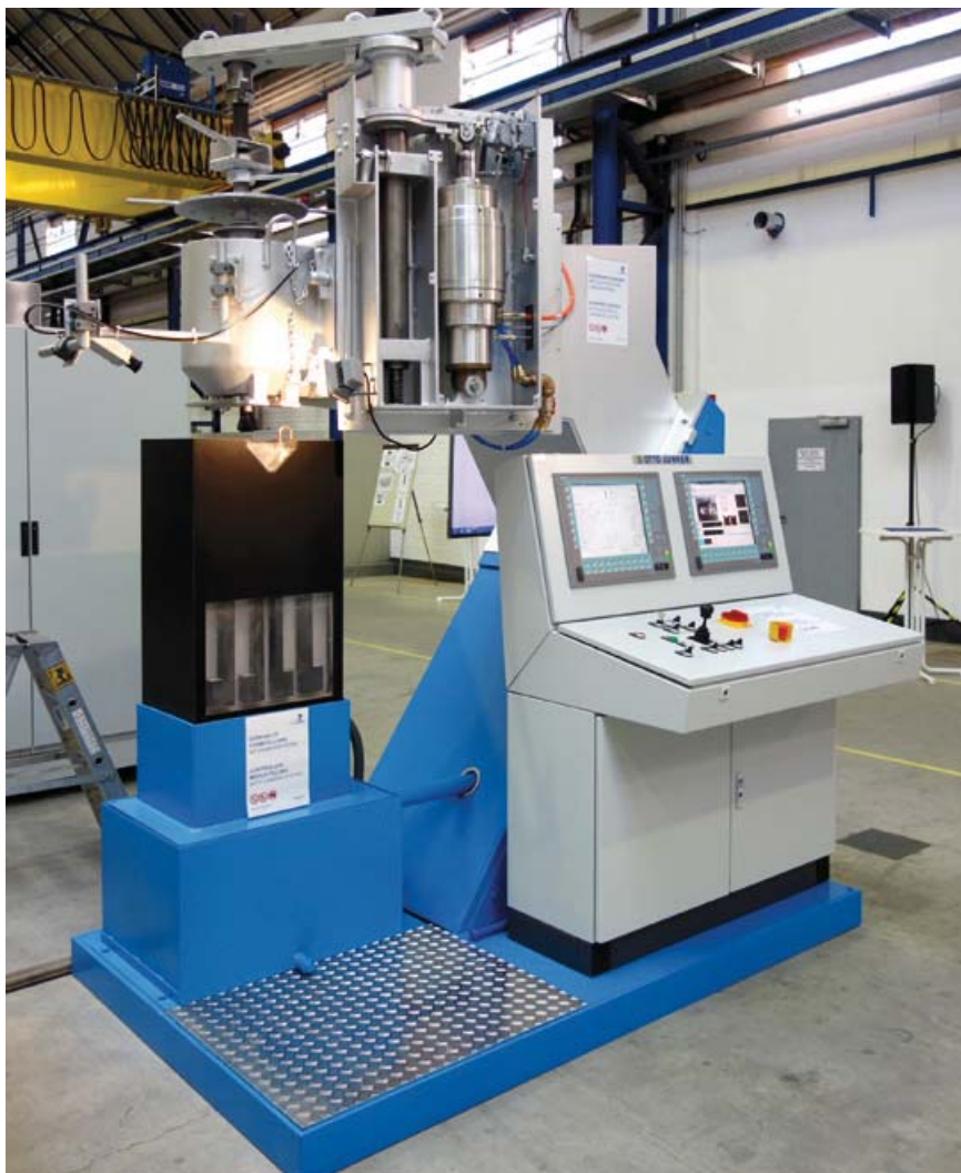
Bild 4: Versuchseinrichtung; neuer Stopfenantrieb und Kamerasystem.
