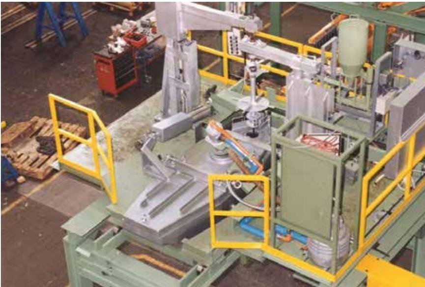
**Bild 4:** Stopfengießeinrichtung, drucklos.
