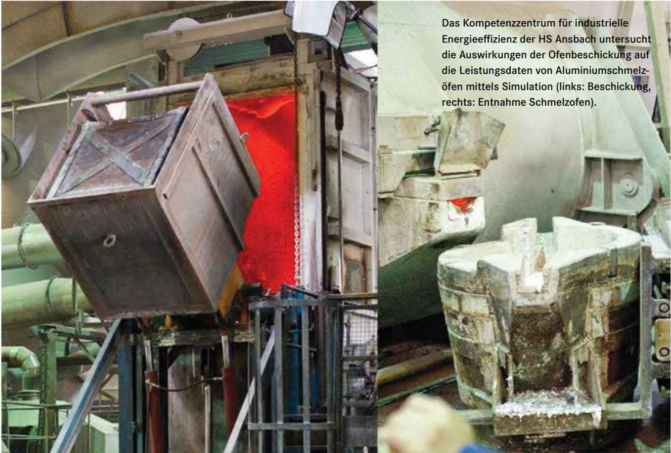
Das Kompetenzzentrum für industrielle Energieeffizienz der HS Ansbach untersucht die Auswirkungen der Ofenbeschickung auf die Leistungsdaten von Aluminiumschmelzöfen mittels Simulation (links: Beschickung, rechts: Entnahme Schmelzöfen).
