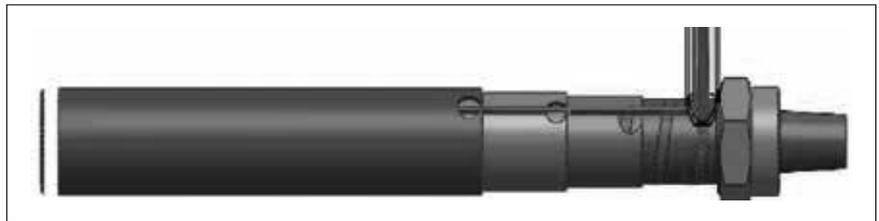
Bild 5: Äußerer Aufbau der Niedrigenergie Düse.
