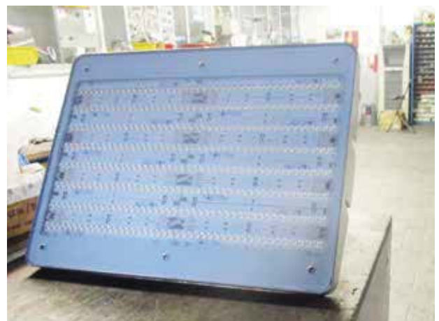
Bild 3: Aufbau der LED-Leuchten. LEDs halten nach Herstellerangaben acht Jahre, deutlich länger als HQL, die nach zwei Jahren ausgetauscht werden müssen.
