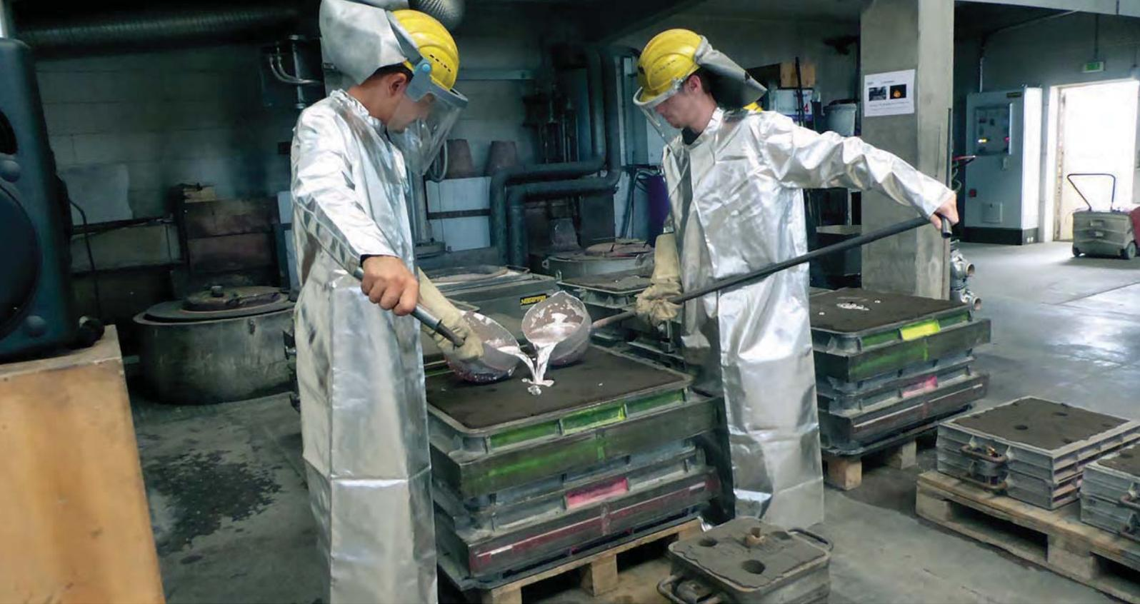
Abguss bei MEGU in Schopfheim. In dem Unternehmen in Südbaden werden Aluminium- und Magnesiumbauteile abgegossen. Ein bedeutender Teil des Energiebedarfs wird mit der gießereieigenen Photovoltaikanlage gewonnen.
