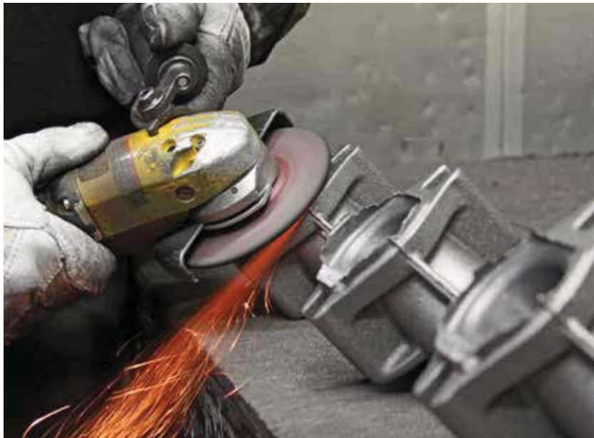
Bild 1: Harz Guss Zorge setzt in Ellrich Turbinenschleifer des Typs GTG 21 von Atlas Copco zum Entgraten, Schruppen und Trennschleifen ihrer Gussteile ein. Durch ein optimal ausgelegtes Druckluftnetz erhalten die Werkzeuge auch den für eine hohe Leistung erforderlichen Druck.
