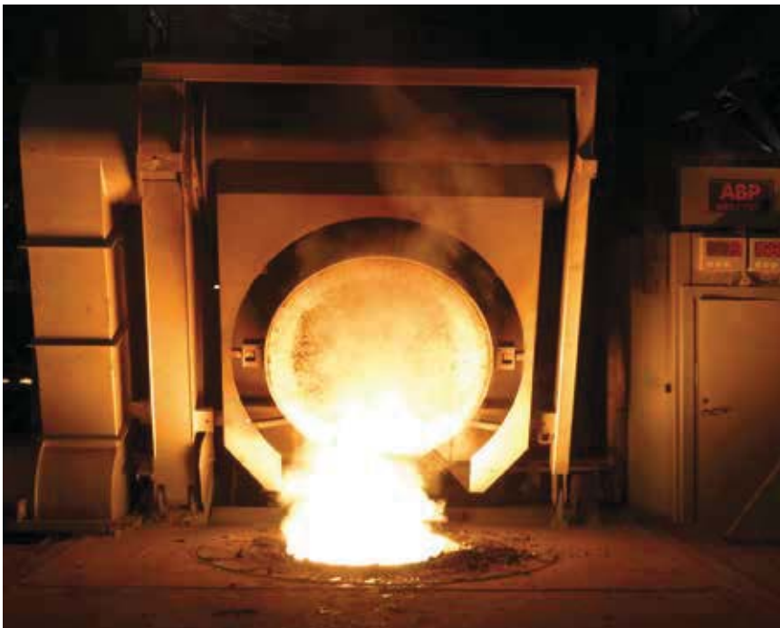
Bild 4: Schmelzen von Ferrochrom in einem der ABP 30-t-/24,4-MW-Öfen in TISCO-Nord [4]
