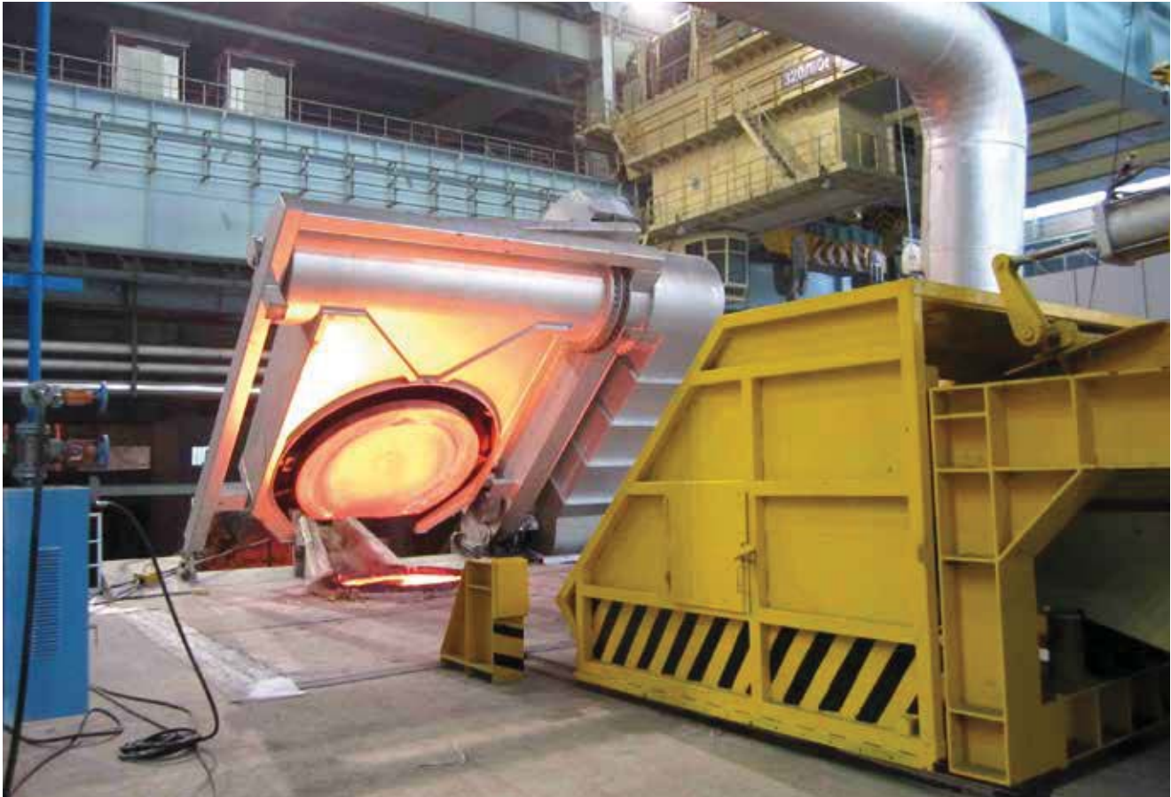
Zum Chargieren bereitstehende Deckel-Absaughaube an einem 30-t-ABP-Induktionstiegelofen.
