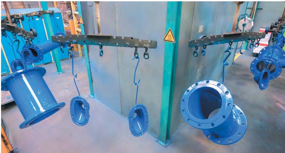
Emallierte Gussteile nach der Beschichtung. Die Emalle hat bei Düker eine lange Geschichte. Namensgeber Friedrich Wilhelm Düker fertigte im Werk Karlstadt vor rund 100 Jahren noch emallierte gusseiserne Baderwannen.
