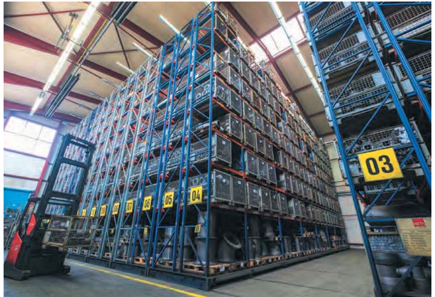
Hochregallager auf dem Werksgelände von Düker in Laufach. Die Regalreihen geben automatisch eine Gasse für Gabelstapler frei, wenn ein Teil angeliefert oder entnommen wird. Zudem verfügt der Staplerfahrer per Tablet über eine Verbindung zum ERP-System.
