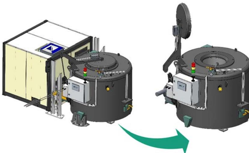
**Bild 2: Mobile Tiegelpfanne mit Heat-Dock. Quelle: Fraunhofer IFF**
