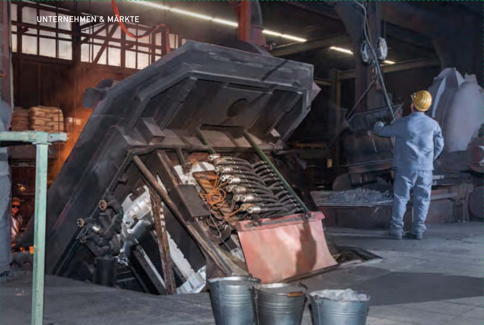
Durch Modernisierung der 3-Tonnen-Gusseisen-Tiegelinduktionsöfen sinken die Energiekosten deutlich.
