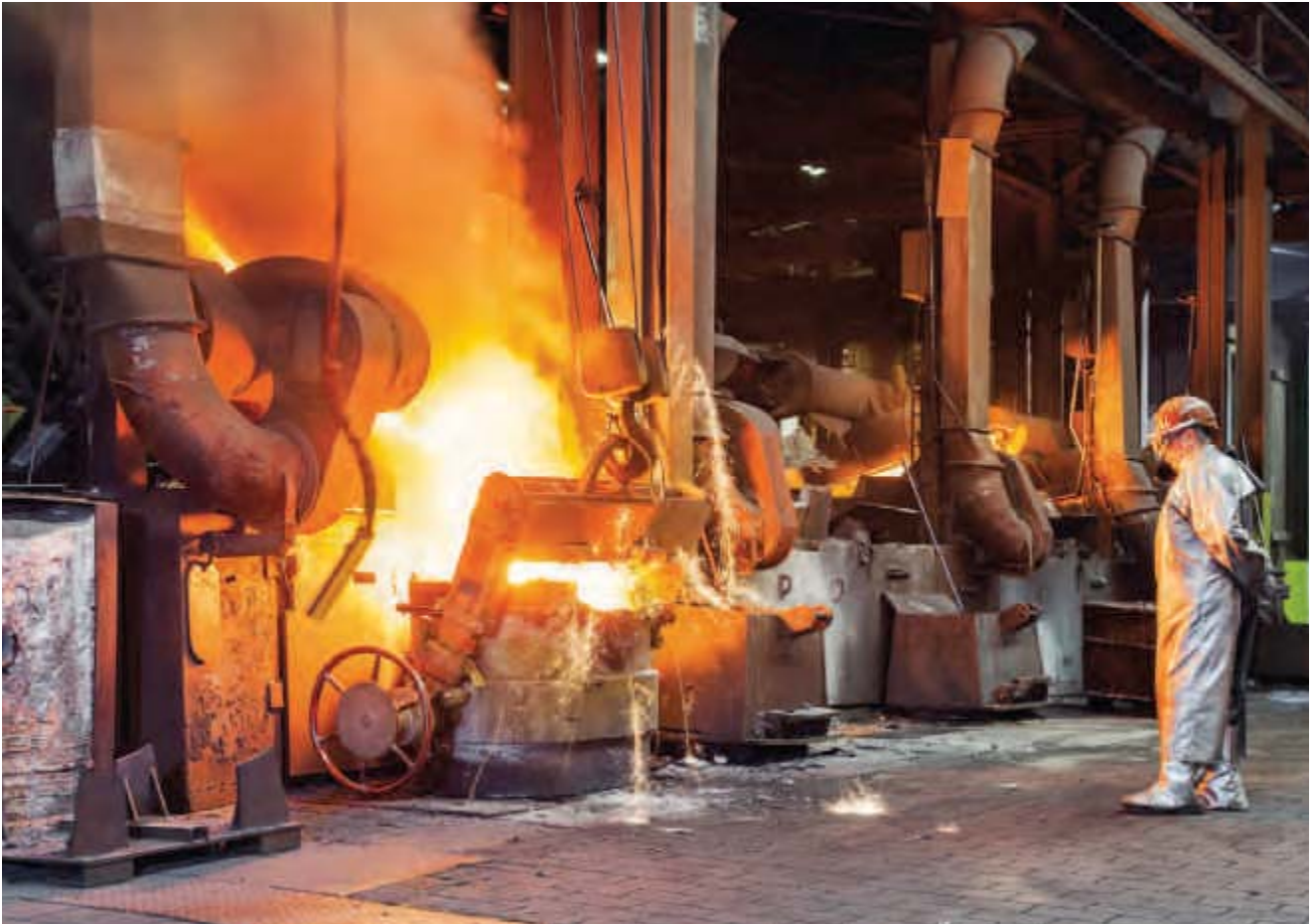
Bild 2: Im Schmelzbetrieb des Gießereibetriebs sind jeweils vier der sieben Otto Junker-Öfen in Betrieb: drei 3-Tonnen-Netzfrequenzöfen sowie ein 4-Tonnen-Trifrequenzofen. Alle Öfen sind auf dem Stand der Technik und teilweise mit modernster verlustarmer Spulentechnik ausgestattet.
