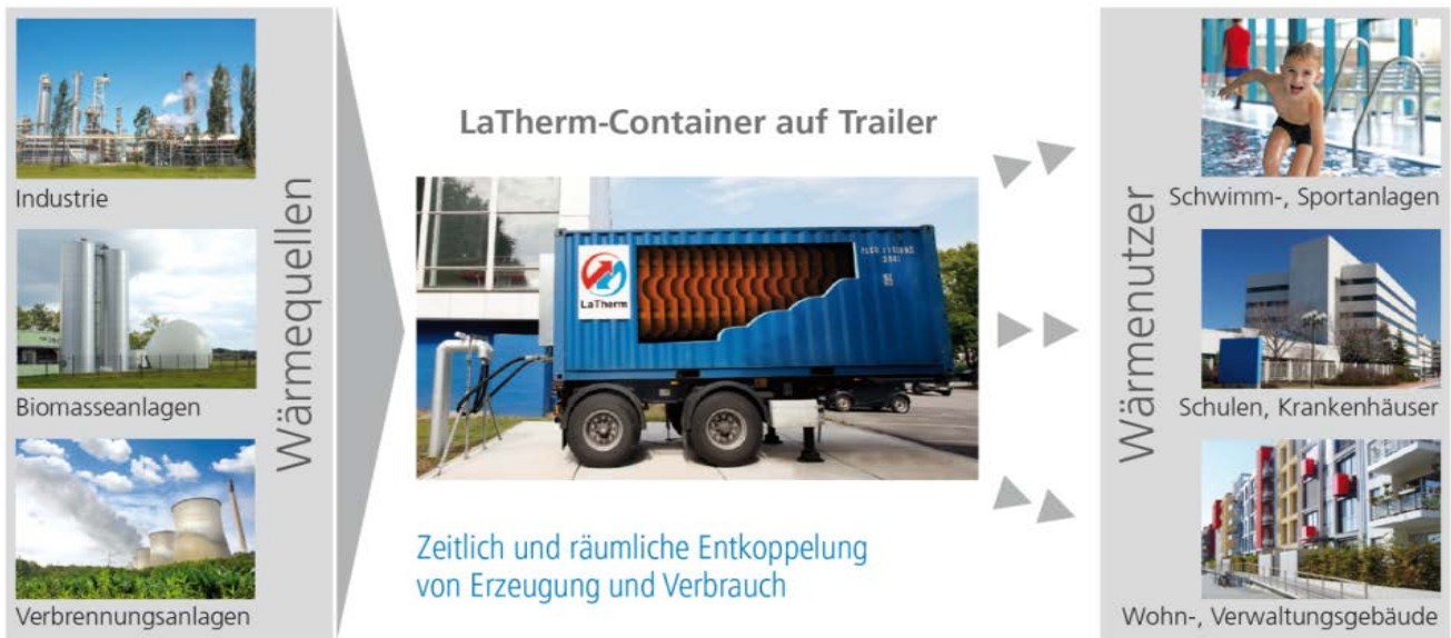
Abbildung 1: Darstellung möglicher Abwärmequellen und Abnehmer der Wärme
