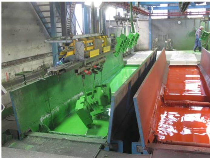
Abbildung 1: Tauchgrundierung
