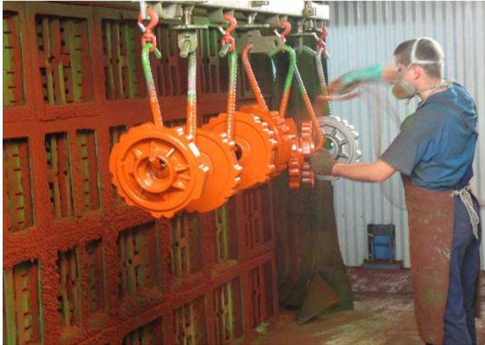
Abbildung 2: Spritzgrundieranlage
